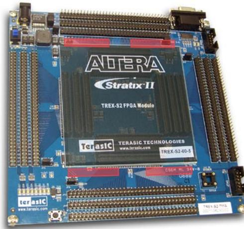
3. 若您使用 TMB Mother Board，拔取時請將 Opener A 端置放於下圖紅色方框處，其他位置請勿使用以避免傷害開發板及板上元件。
