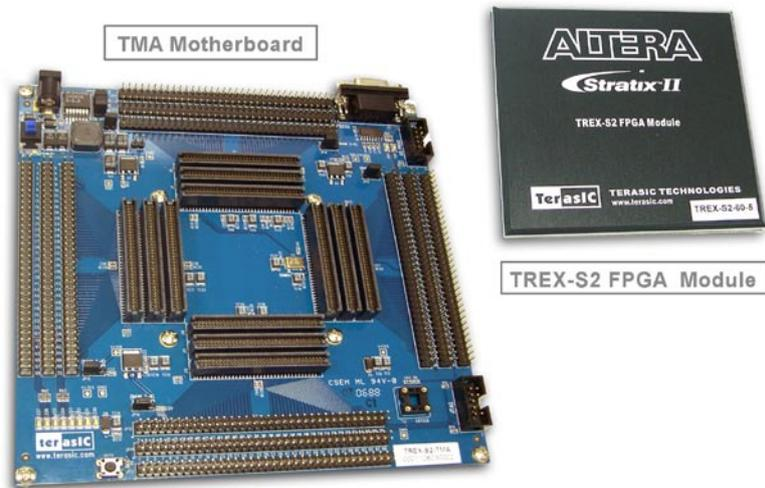
2. TREX-S2 FPGA Module與Mother Board文字面朝上，將Terasic Logo旋轉至Board左下方，並且放入對應的Connector上。
